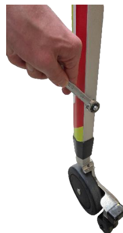
Imaginea 15 Reglarea înălțimii piciorului de sprijin din față
